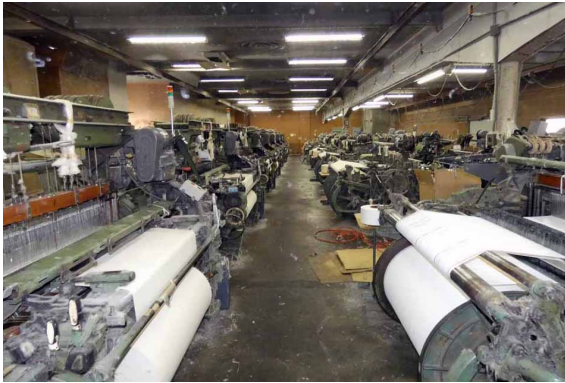
写真 1 タケヤリのピカノール製シャトル織機 (2019. 3. 1 筆者撮影)
