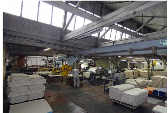
写真5 丸進工業の鋸屋根工場(検反と畳み機の工程)(2019.2.28 筆者撮影)
