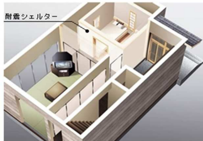
住宅に設置する 耐震シェルターの事例
