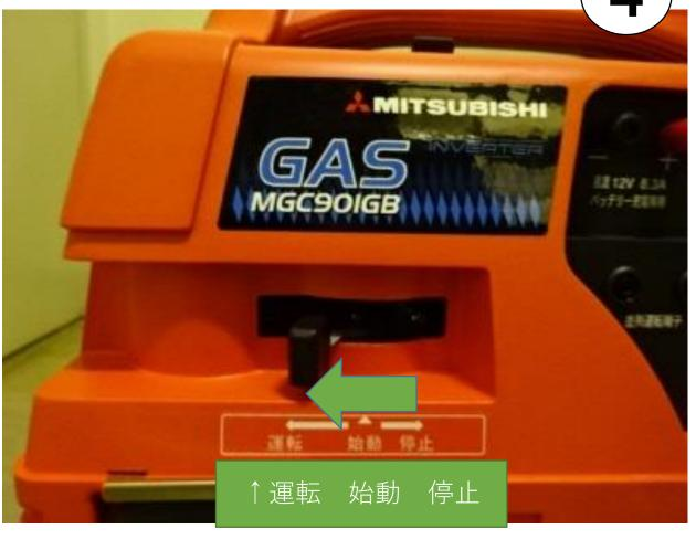
引っ張ると「ブルブル」と 音が出るので、始動するま で強く引く。 始動後2分ほどして音が安定した ら『始動』から『運転』に移す。 電気の供給が開始される。
