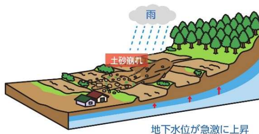
地下水位が急激に上昇
