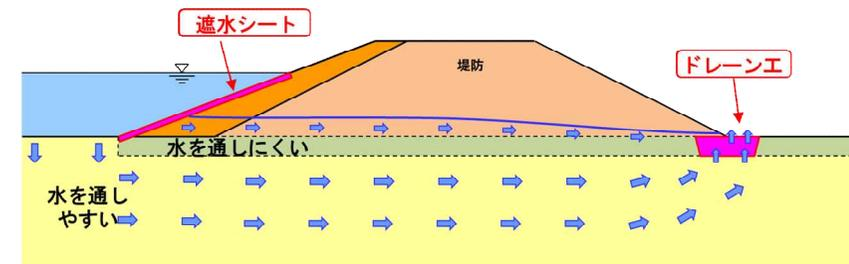
※堤防直下は水を通しにくい粘土層になっているため、その下を流れる地下水の上昇圧力を軽減するための処置を実施
