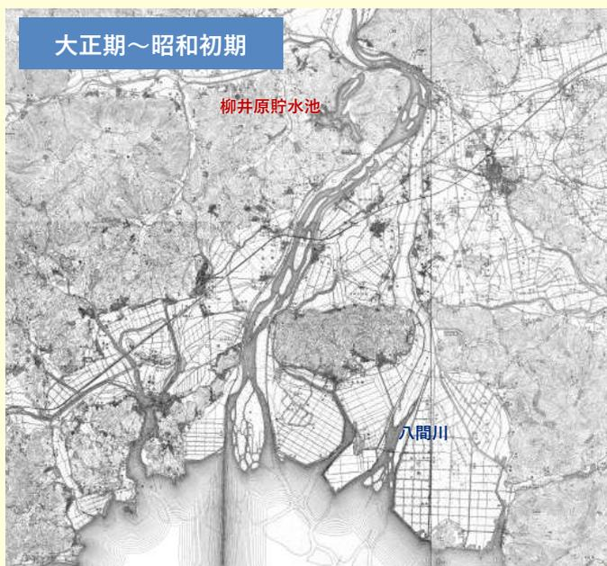
明治44年の起工から、大正14年の竣工により酒津で東高梁川のせき止め堤防がつくられ、東高梁川は廃川となり、西高梁川の一部は締め切られ、柳井原貯水池として整備されました。
