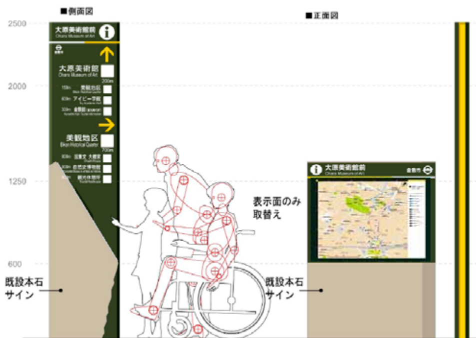
図 既存サイン施設を活用した案内サイン施設
