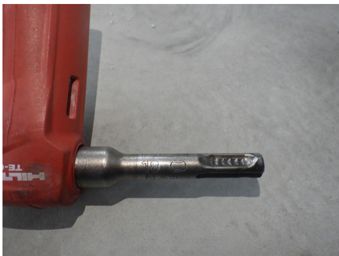
（3）アンカーボルト削孔径の確認
