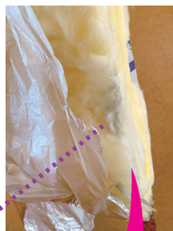
繊維系断熱材 (グラスウール)の 取り扱いは注意!
