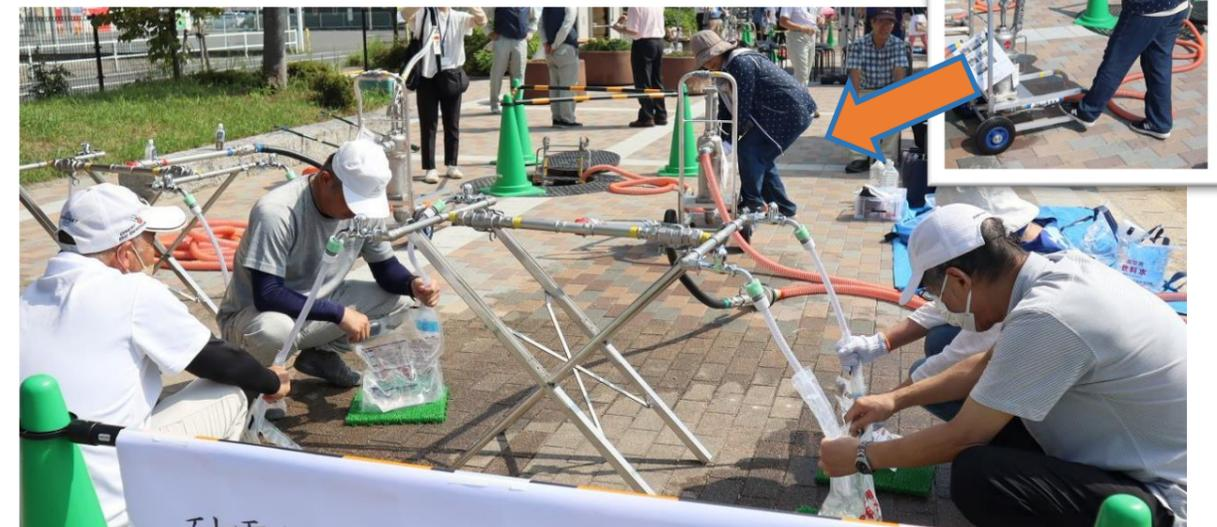
災害が発生しパトランプが点灯すると、器具庫にある手動ポンプ、応急給水栓などを使い、市民の皆様が自ら水をくみ上げて給水できます。
