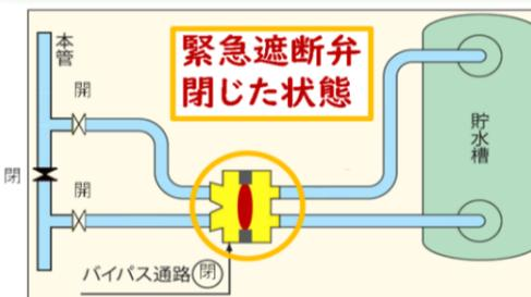
地震などによる水圧低下を感知すると、緊急遮断弁が作動し、独立した貯水槽となる仕組みだよ。
