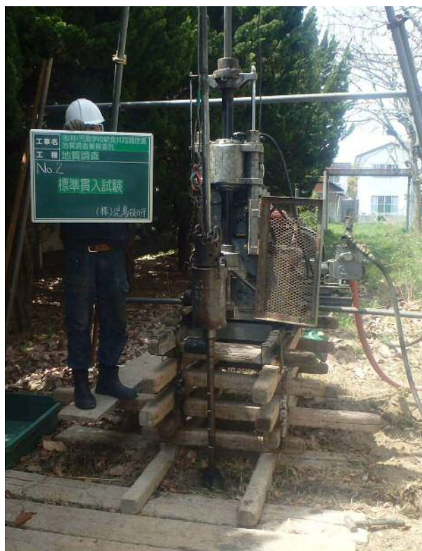
図 1-1) ハイドロリックフィードタイプのボーリング装置全体図
