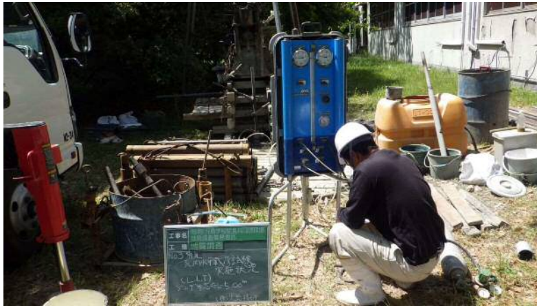
孔内載荷試験 G. L. -5.00m
