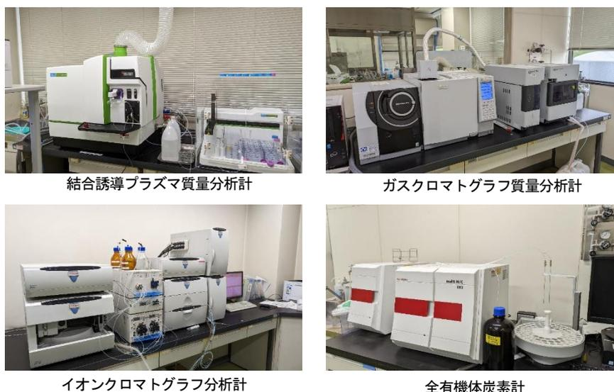
図10 水質検査に用いる分析機器
