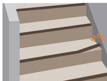
階段の滑り止めの浮き
