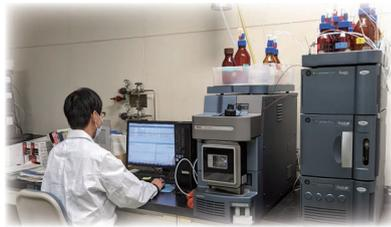
有機フッ素化合物の水質検査装置
