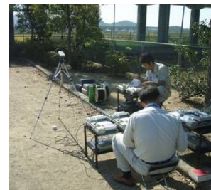
新幹線騒音振動測定
