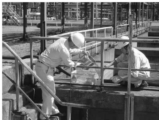
工場排出水の採水
