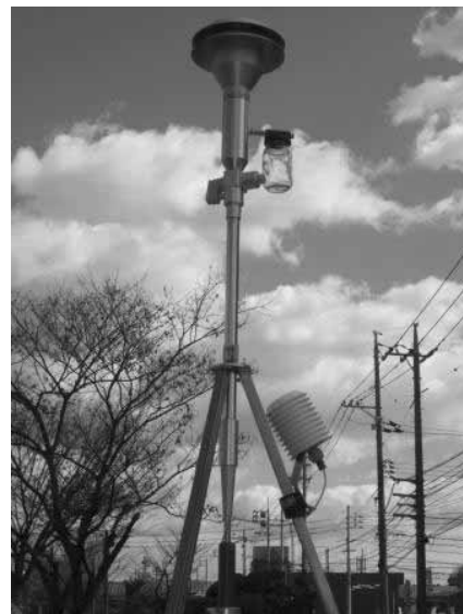
PM2.5 自動測定機 試料導入部
