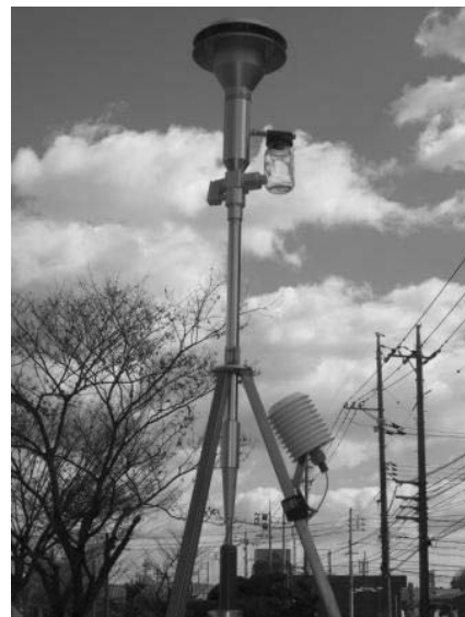
PM2.5 自動測定機 試料導入部
