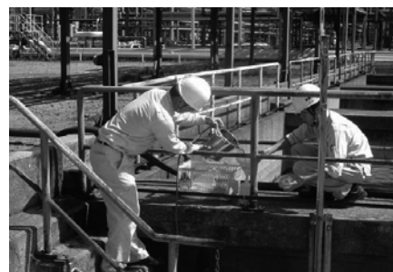
工場排出水の採水
