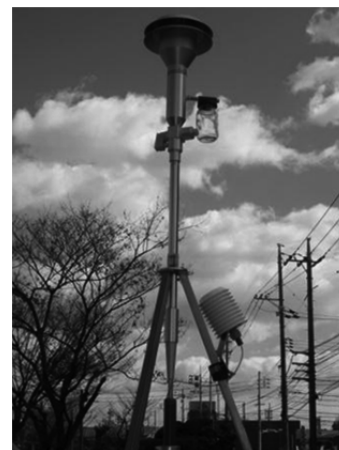
PM2.5 自動測定機 試料導入部
