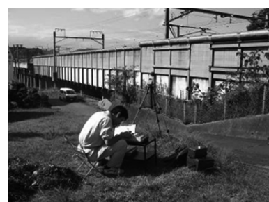
瀬戸大橋線の騒音測定
