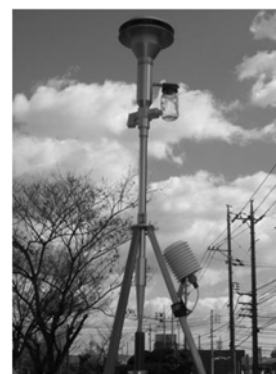
PM2.5 自動測定機 試料導入部
