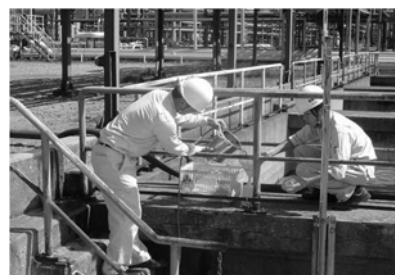
工場排出水の採水
