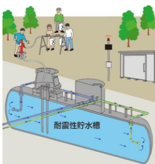
▲耐震性貯水槽
