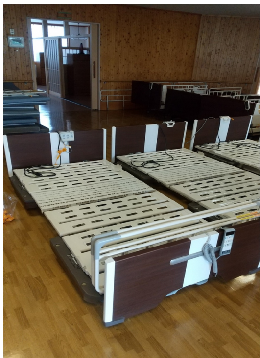
写真：介護ロボット（センサー付きベッド）
