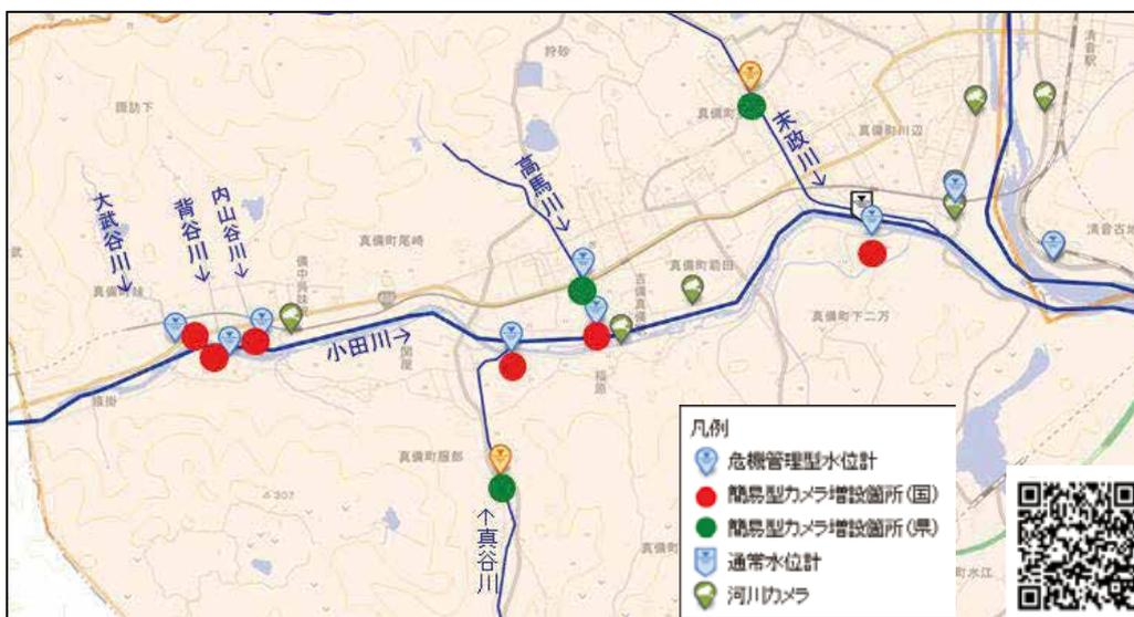
※危機管理型水位計は、河川の堤防天端(堤防の最上面)から水面までの距離を測定する。
