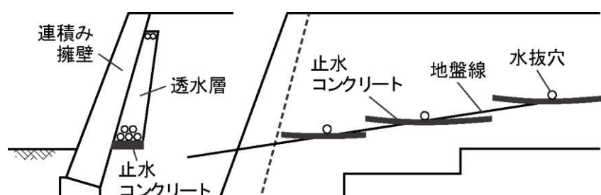
図 3.4.8 止水コンクリート
